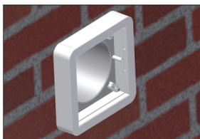
Fixe a veneziana com o auxílio de massa de cimento junto ao colarinho, ficando a parte plástica para fora da edificação.
