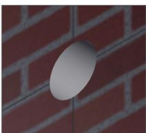
Com auxílio de uma talhadeira ou serra copo, realize o furo para passagem do tubo.
